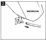
Remove the fuel line. Rimuovere il tubo benzina.
