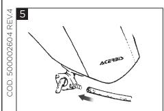
Reinsert the fuel line. Reinserire il tubo benzina.
