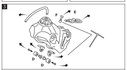
Remove the seat screw, elastic attach, frame attach and fuel gas cup line. Rimuovere vite sella, attacco elastico, attacchi telaio e tubo benzina.
